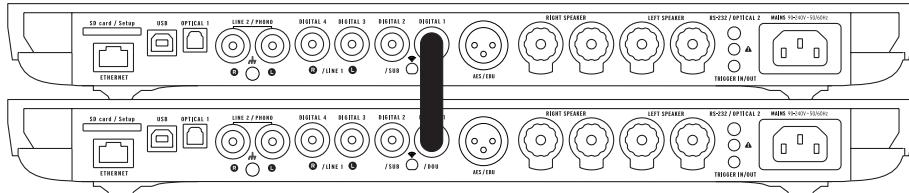
Um den Dual Mono-Modus zu aktivieren, schließen Sie jede Lautsprecherbox an ein Gerät an und verbinden Sie diese über ein Digitalkabel (SPDIF oder SPDIF-AES/EBU) miteinander.
